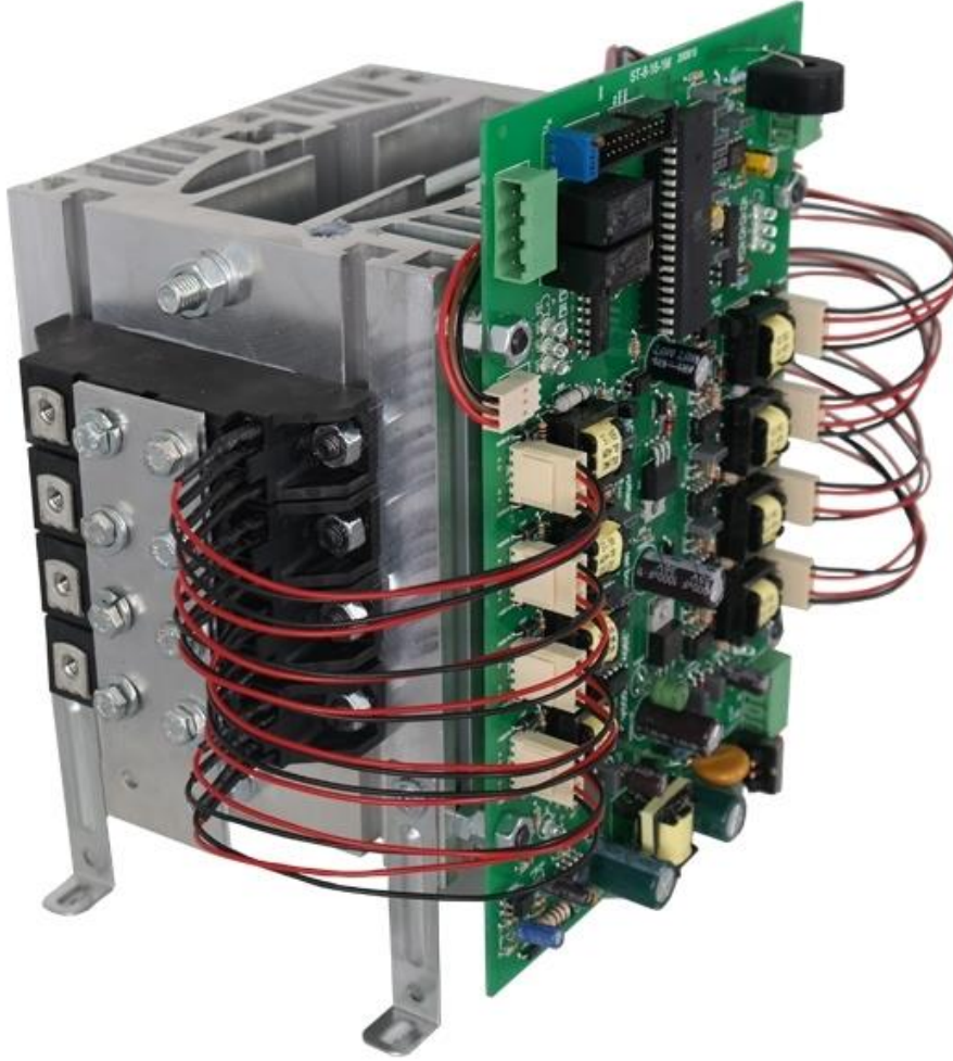
ELEKTRONİK KART VE THYRISTOR-MODULE SOĞUTUCU BAĞLANTISI
