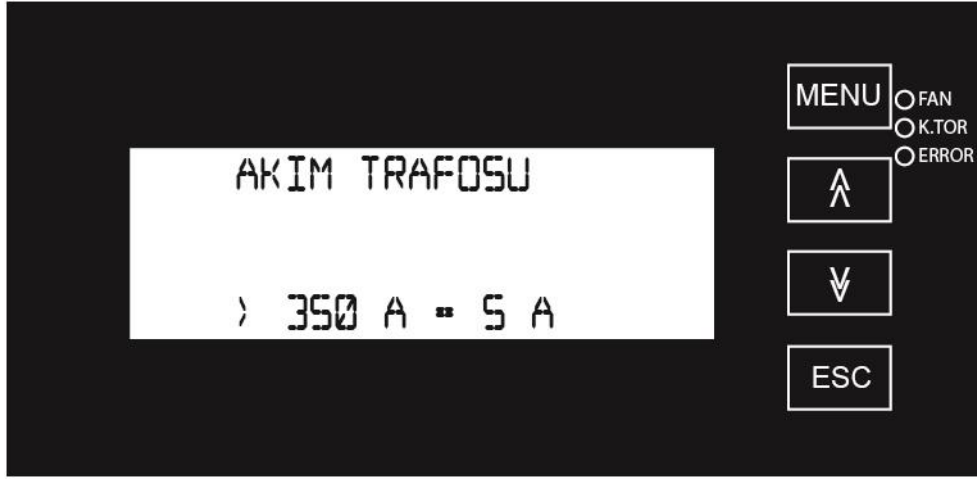
Resim11: Akım trafosunun deęiřimi
